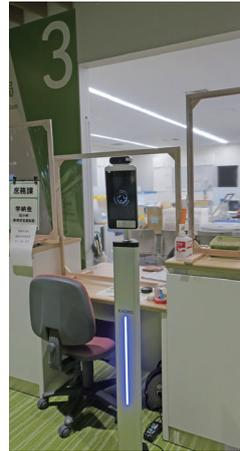
事務局カウンターに設置された検温機と手作りの仕切り板
